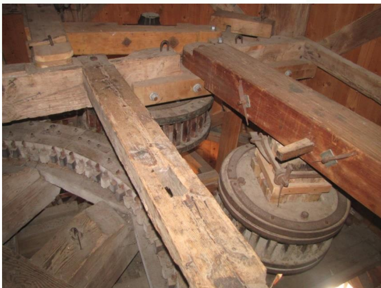
Figuur 46 Scheer en ijzerbalken. Rechts een pelschijf en boven een steenschijf.
