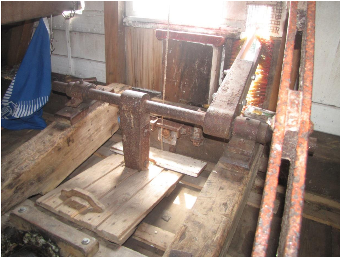
Figuur 38 Hefboomstelsel voor het heen en weer bewegen van de zwichtstang. Rechts de mast die gelijk is voorzien van een schijf voor de bedieningskettingen.
