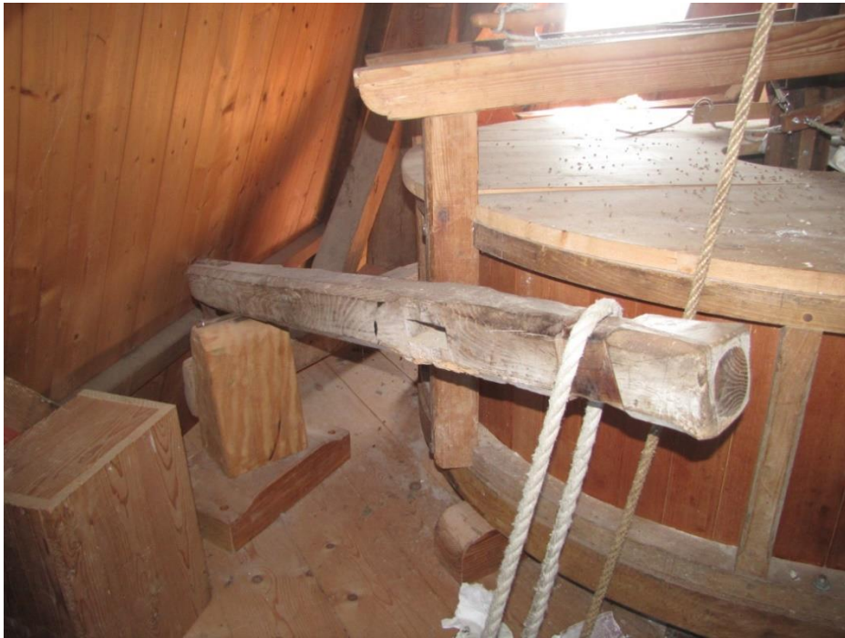
Figuur 55 Lichtstok en balk op de steenzolder.
