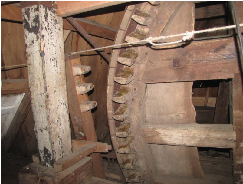
Figuur 40 Voorzijde van het asrad met kruisarmen die met een tand in het beleg schieten. De brugconstructie voor de voeghouten is hier ook goed te zien.
