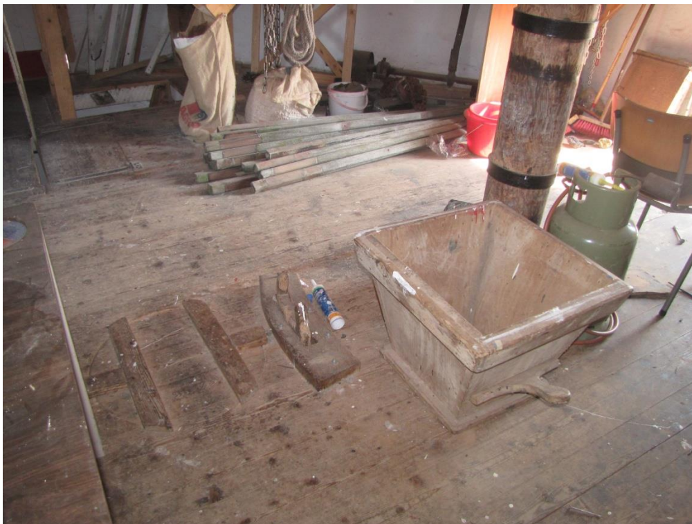
Figuur 58 Van links naar rechts: luik voor schootemmer, schuif, kaar en pelspil.
