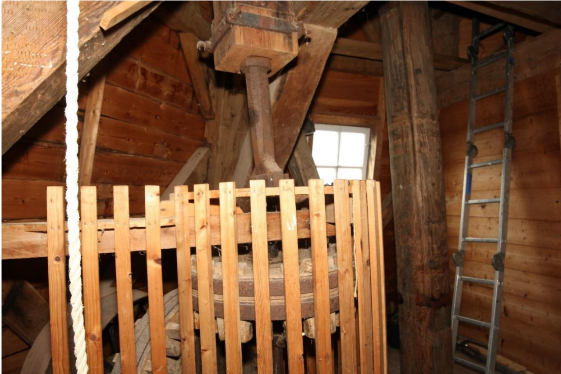
Afbeelding 4.65: De steenzolder met door latten afgeschermdde spil en wielen voor de aandrijving van de haverpletter op de stellingzolder.
