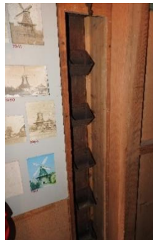
Afbeeldingen 4.18, 4.19 en 4.20: Stortkoker voor de gort vanaf de eerste zolder, jakobsladder met aandrijving voor transport van gort vanaf de begane grond naar de halfschilhokken.
