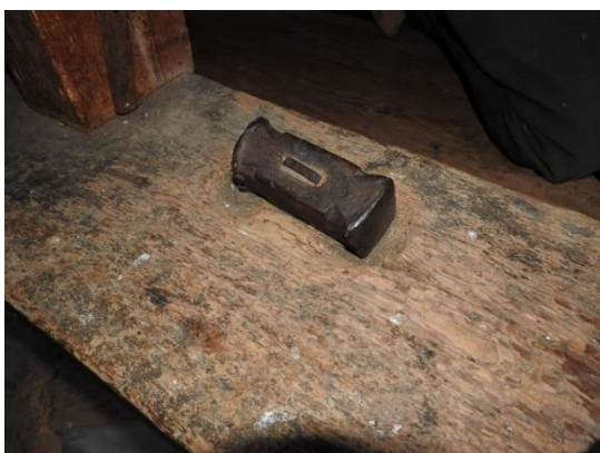
Afbeeldingen 4.93, 4.94, 4.95, 4.96 en 4.97: Oude hamer (vuistje) die in één van de hekstockgaten van de voormalige roede kan worden gestoken. De hamer is aan de onder- en bovenzijde in de hoeken voorzien van gesmede inkepingen (rechtsonder).
