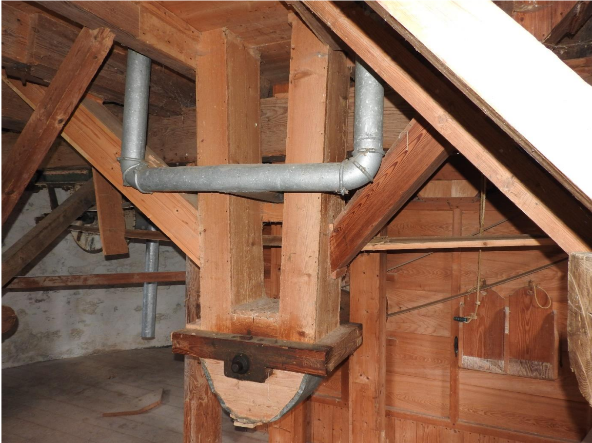
Afbeelding 4.42: De jakobsadders, met op de achtergrond de wanmolen. Midden boven de buis voor de stofafzuiging van de pelstenen op de dustvloer. Rechts onder de schotjes voor de lichte en zware gort in de wanmolen, die kan worden opgevangen doordat gewichtjes de schotjes omhoog trekken.
