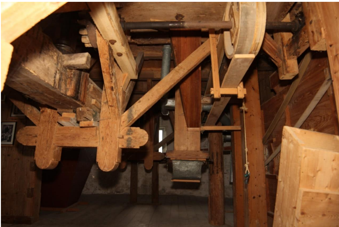
Afbeelding 4.41: De horizontale as met links de tandwielen die (als de naloper in het werk staat) de stofafzuiging (midden rechts) en de wanmolen (uiterst rechts) aandrijven.
