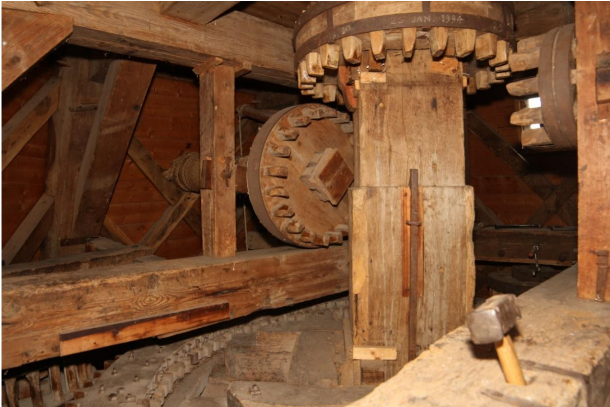
Afbeelding 4.80: Het luiwiel (links), de bovenbonkelaar (midden boven), het spoorwiel (midden onder) en het wiel voor de aandrijving van de jakobladders (rechts). De bovenbonkelaar drijft het luiwiel en het wiel van de jakobladders aan. Het spoorwiel drijft de spillen van de malerij, pellerij en pletter aan.
