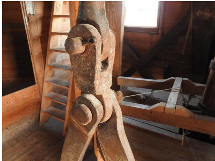
Afbeelding 4.63 en 4.64: Links de staander van de oude steenkraan op de steenzolder. Rechts de bevestiging van de kraanbeugels van de steenkraan. De kraanbeugels kunnen zo nodig hoger bevestigd worden, zodat de steen over de bolspil heen kan wordt gedraaid.
