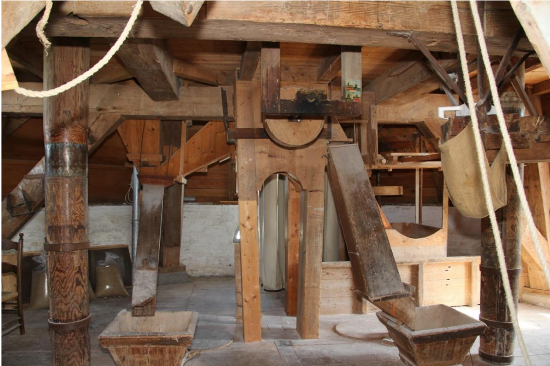
Afbeelding 4.48: Overzicht van de stellingzolder met de pelspillen, stortkokers en pelkaren voor de pellerij. In het midden de jakobsadders. Achter de jakobsadders de stofafzuiging en rechtsachter de zeperij van de pellerij.
