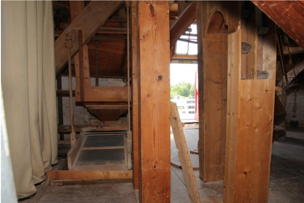
Afbeelding 4.54: De zeverij van de pellerij op de stellingzolder, waarmee de gort op korrelgrootte gezeefd wordt. Links de zakken voor de stofafzuiging. Midden de jakobsladders voor de gerst, die van de begane grond naar de halfschilhokken wordt getransporteerd. Rechts de jakobsladders met bakjes, waarmee de gort wordt getransporteerd van de voorloper naar de naloper en van de naloper naar de pellerij.
