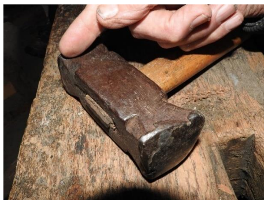
Afbeeldingen 4.93, 4.94, 4.95, 4.96 en 4.97: Oude hamer (vuistje) die in één van de hekstockgaten van de voormalige roede kan worden gestoken. De hamer is aan de onder- en bovenzijde in de hoeken voorzien van gesmede inkepingen (rechtsonder).
