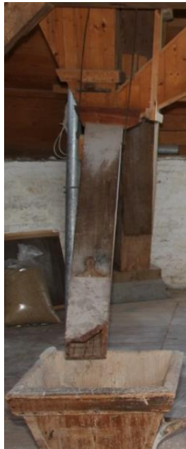
Afbeeldingen 4.49, 4.50 en 4.51: Pelspil van de voorloper (links), stortkoker en pelkaar van de voorloper (midden) en jakobsadders (rechts).
