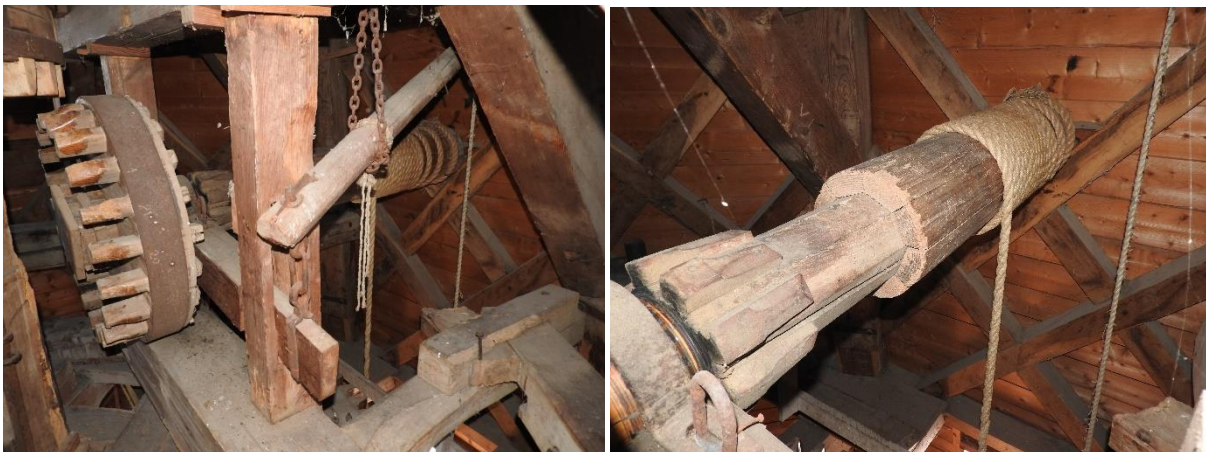
Afbeeldingen 4.81 en 4.82: Het luiwerk van de molen, voor het hijsen van de graanzakken. Door het draaien van het luiwiel (links) wordt het luitouw om de luirol gerold (rechts), zodat de zakken naar boven worden getakeld. De wielen draaien naar één kant, waardoor er alleen kan worden gehesen op windkracht. 21
