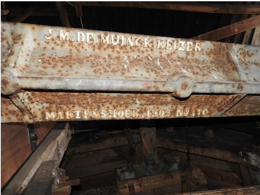
Afbeelding 4.99: De gietijzeren bovenas van J. M. de Muinck Keizer uit 1903 met het nummer 110 op de kapzolder.
