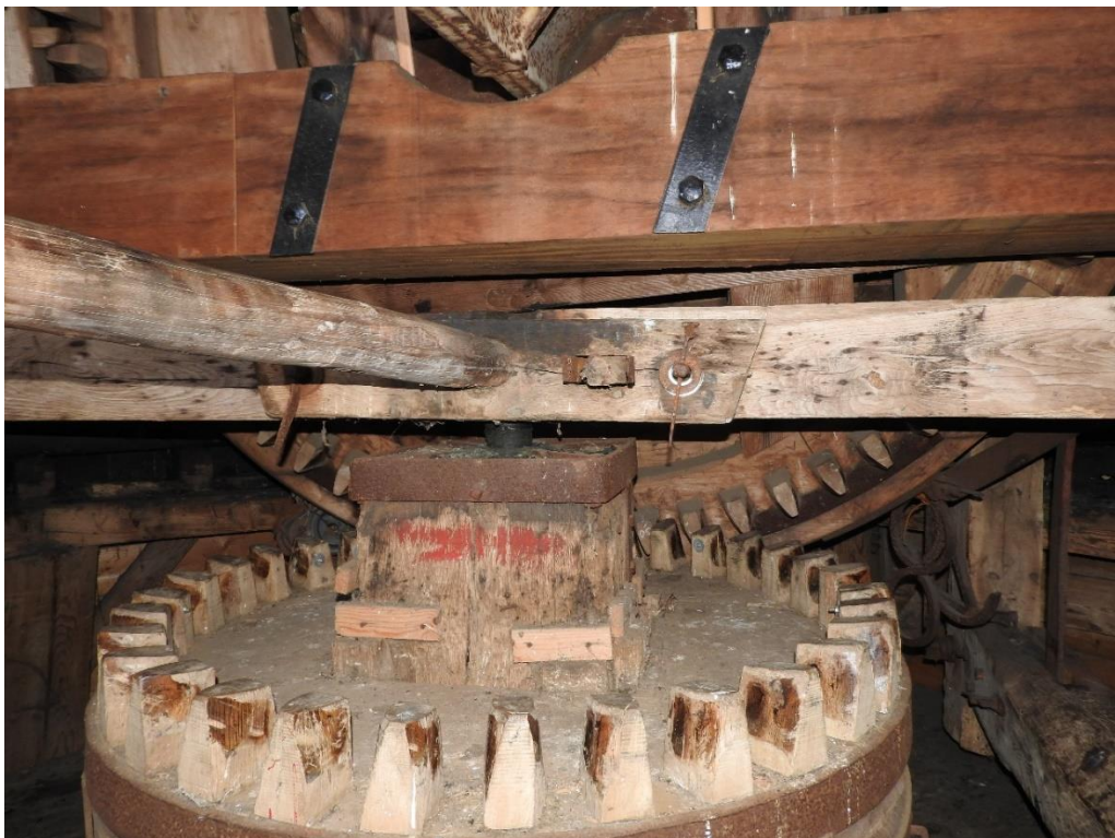
Afbeelding 4.101: De bovenbonkelaar (onder), die voor de overbrenging van het bovenwiel naar de koningsspil zorgt. Midden boven de poortstok, busdeur en middenbalk of ijzerbalk. De poortstok is een extra mogelijkheid om de busdeur op zijn plek te houden. 22
