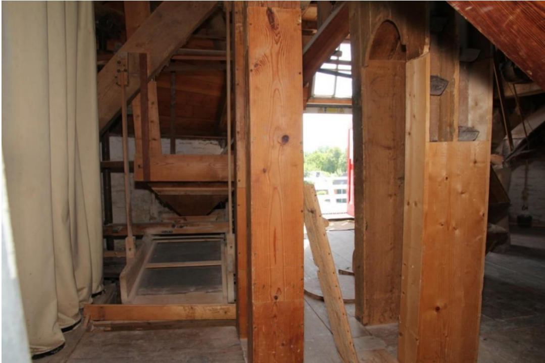
Afbeelding 4.52: De zeverij van de pellerij op de stellingzolder, waarmee de gort op korrelgrootte gezeefd wordt. Links de zakken voor de stofafzuiging. Midden de jakobsladders voor de gerst, die van de begane grond naar de halfschilthokken wordt getransporteerd. Rechts de jakobsladders met bakjes, waarmee de gort wordt getransporteerd van de voorloper naar de naloper en van de naloper naar de pellerij.
