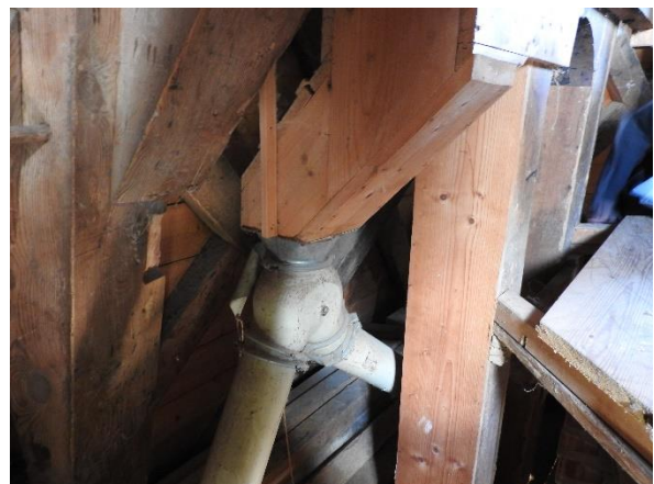
Afbeeldingen 4.78 en 4.79: Bovenzijde van de transportbuis (links) en verbinding met storkoker van de jakobs ladder (rechts). Ook bij deze verbinding zat een schuif voor de toegang naar één van beide halfschilhoeken.
