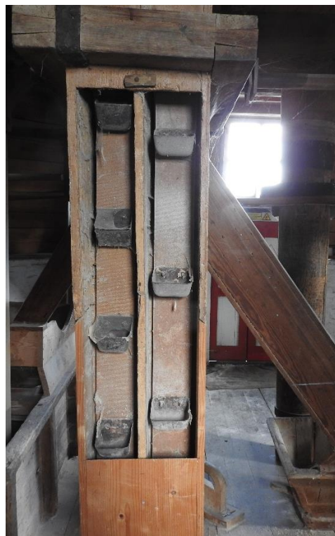
Afbeelding 4.56: De jakobsladders: links van de voor- naar de naloper en rechts van de naloper naar de pellerij.
