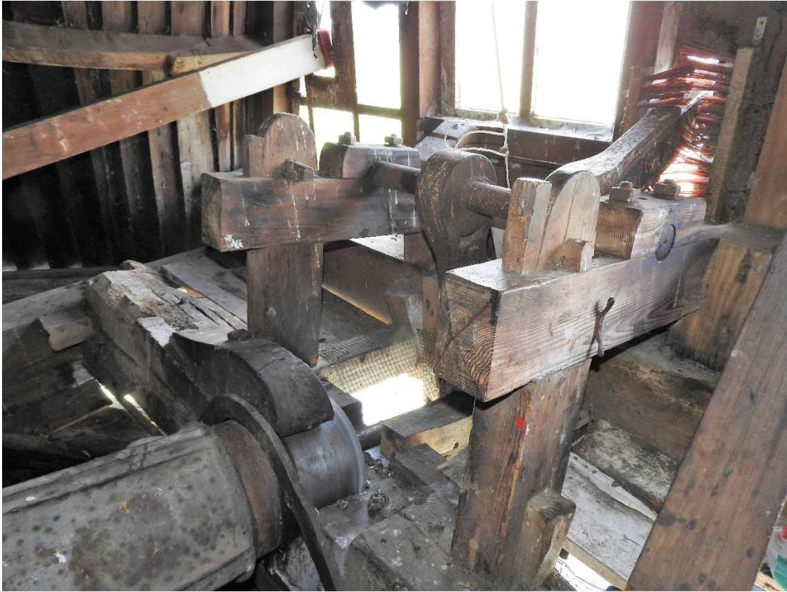
Afbeelding 4.104: Het achterkeuvelens met bovenas (linksonder), bok, harp en zwichstang (midden) aan de achterzijde van de molen. Via de zwichtketting aan de achterzijde van de molen wordt de zwichstang bediend, die de door de bovenas loopt en de zelfzwichtkleppen kan openen of sluiten.
