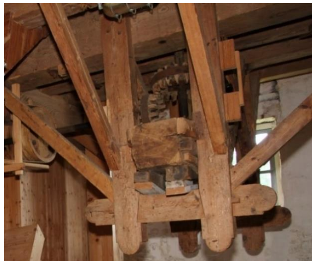
Afbeelding 4.39: De naloper van de pellerij met tandwielen voor het aandrijven van de as van de waaierkast en de stofafzuiging.
