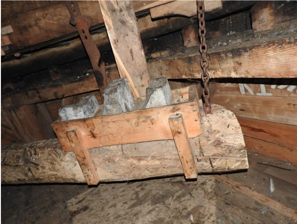
Afbeelding 4.102: De binnenvangbalk met binnenvangketting. Door aan de vangketting die aan de buitenvangbalk is bevestigd te trekken, gaat de vangbalk omhoog wordt deze aan de haak gehangen. Zo is de vang los, waardoor de bovenas kan gaan draaien. Om de molen stil te zetten, trekt de molenaar de vangbalk van de haak en laat hem geleidelijk zakken, waardoor de stalen bandvang rondom het bovenwiel geklemd wordt en de molen stil komt te staan. 23
