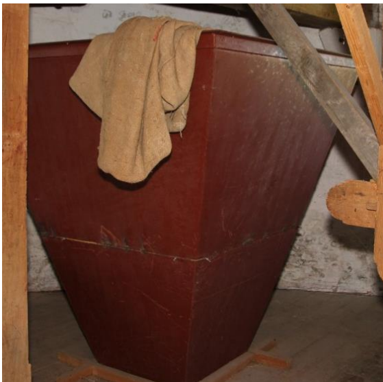
Afbeelding 4.35: De opslagsilo voor de haver uit de pletter op de stellingzolder.
