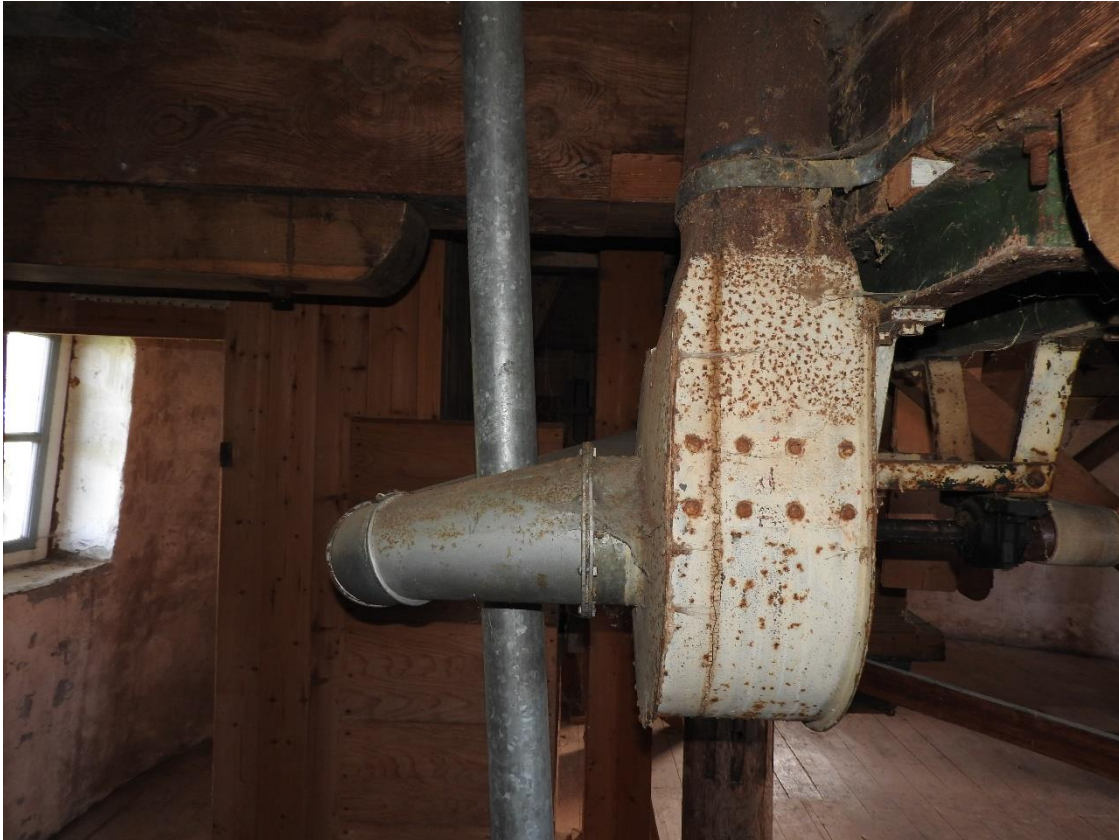
Afbeelding 4.40: De aandrijving van de stofafzuiging voor de pelstenen op de dustvloer op de wanzolder. Deze is in 1973 aangebracht voor de molenaar en zijn gezondheid. Hierdoor had de molenaar minder last van stof. De verticale buis in het midden was voor transport van de gort naar beneden.
