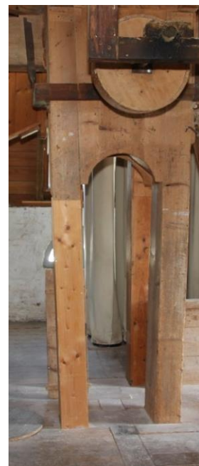
Afbeeldingen 4.49, 4.50 en 4.51: Pelspil van de voorloper (links), stortkoker en pelkaar van de voorloper (midden) en jakobsadders (rechts).
