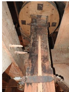
Afbeelding 4.65: De steenzolder met door latten afgeschermdde spil en wielen voor de aandrijving van de haverpletter op de stellingzolder.
