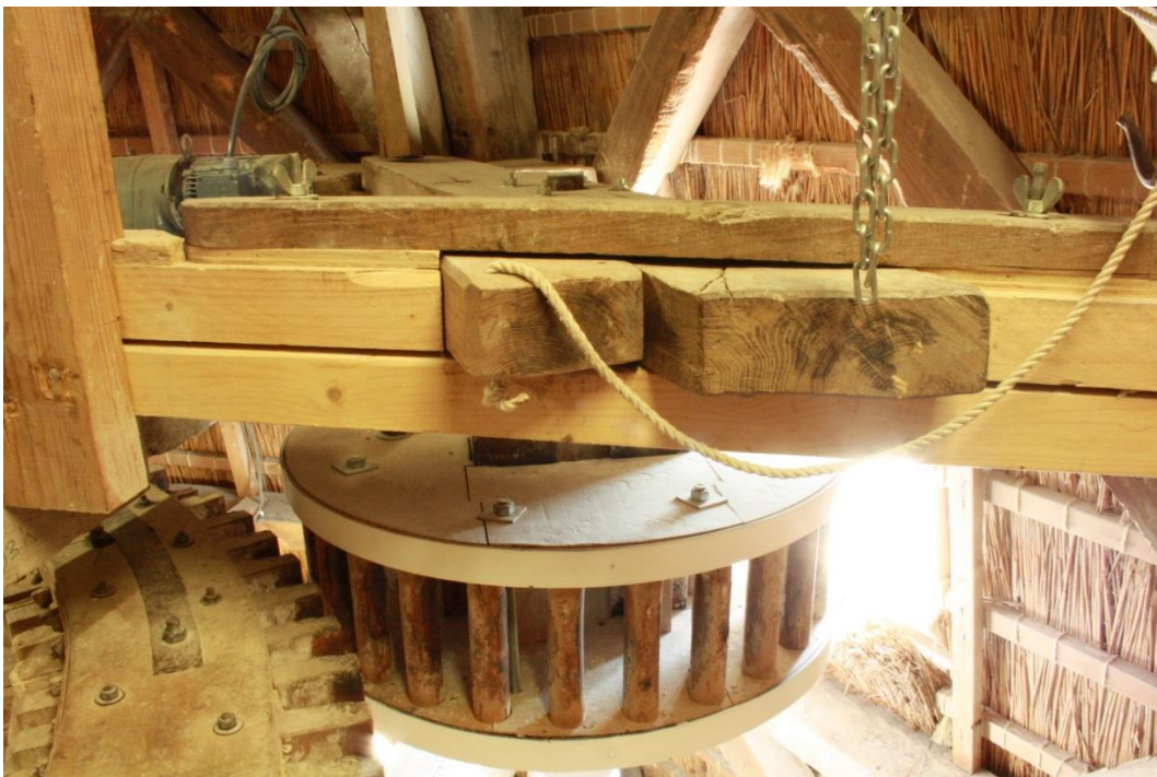
Afbeelding 4.34: De maalschijfloop van de flintsteen op de luizolder. Links het spoorwiel.
