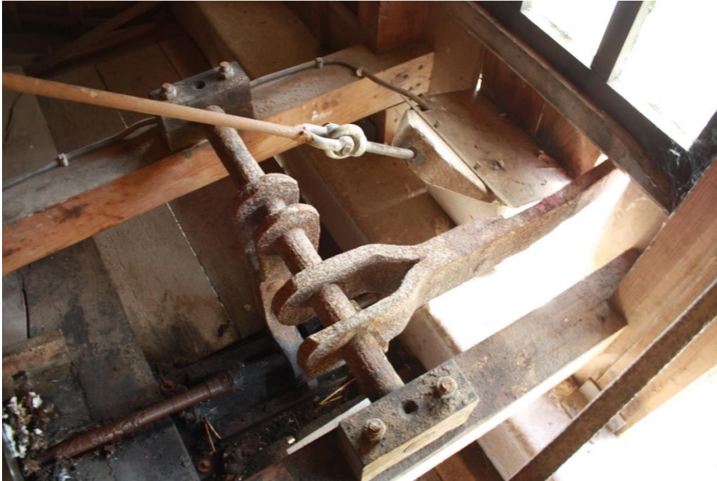
Afbeelding 4.47: De zwichtinrichting met bok met harp naar zwichtstang, die in de bovenas zit. Boven de trekstang naar de bovenzijde van de staart.
