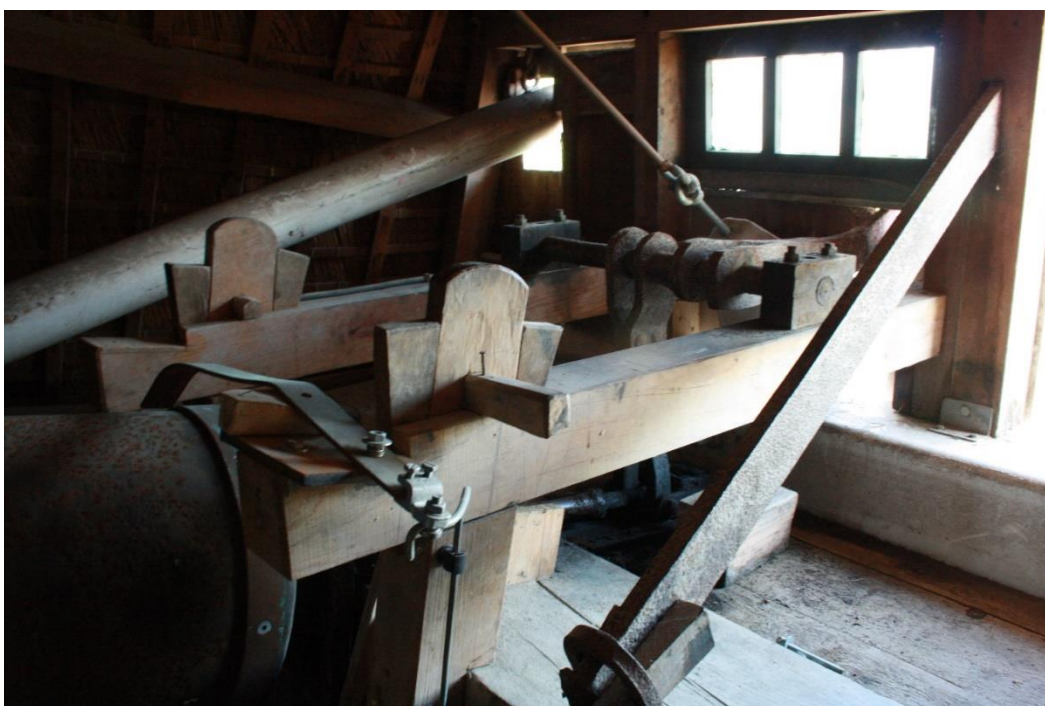
Afbeelding 4.46: De zwichtinrichting met trekstang achter in de kap. Linksboven de vangstok, die is gemaakt van aan elkaar gelaste buizen, die verlopen van grote naar kleinere diameters (binnen groot, buiten kleiner).
