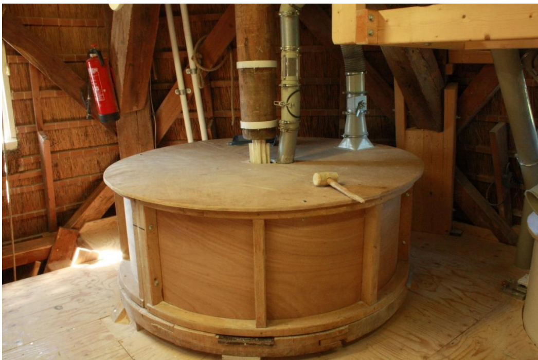
Afbeelding 4.27: Het tweede koppel maalstenen waarmee evenals de flintsteen gemalen wordt. De loper van dit koppel stenen is een barksteen. Deze steen is vroeger gebruikt voor het malen van de schors van de eikenbast, dit met name voor de leerlooierijen en voor het tanen van netten, touwwerk en zeilen, op de steenzolder.
