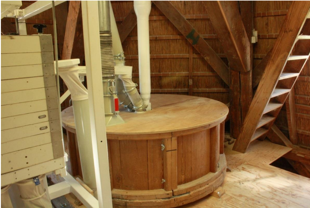
Afbeelding 4.24: De maalinrichting met de flintsteen, waarin het graan gemalen wordt, op de steenzolder.
