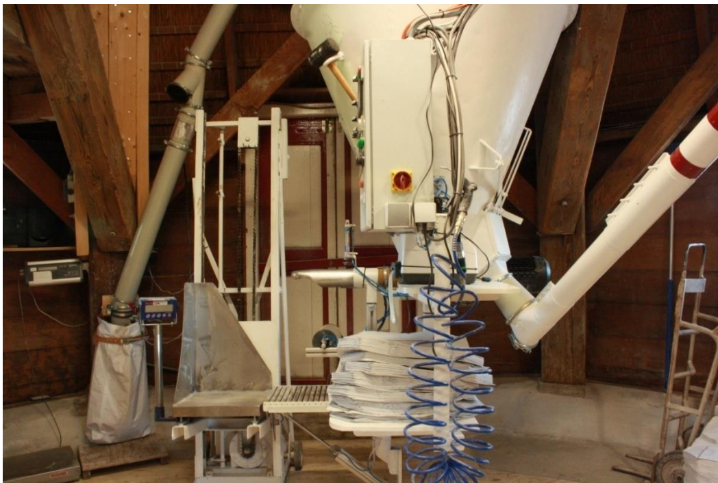
Afbeelding 4.20: De menger op de begane grond. De molen kreeg bij de restauratie van 1979-1981 een efficiënte, (deels) geautomatiseerde inrichting voor het opzakken van het eindproduct.
