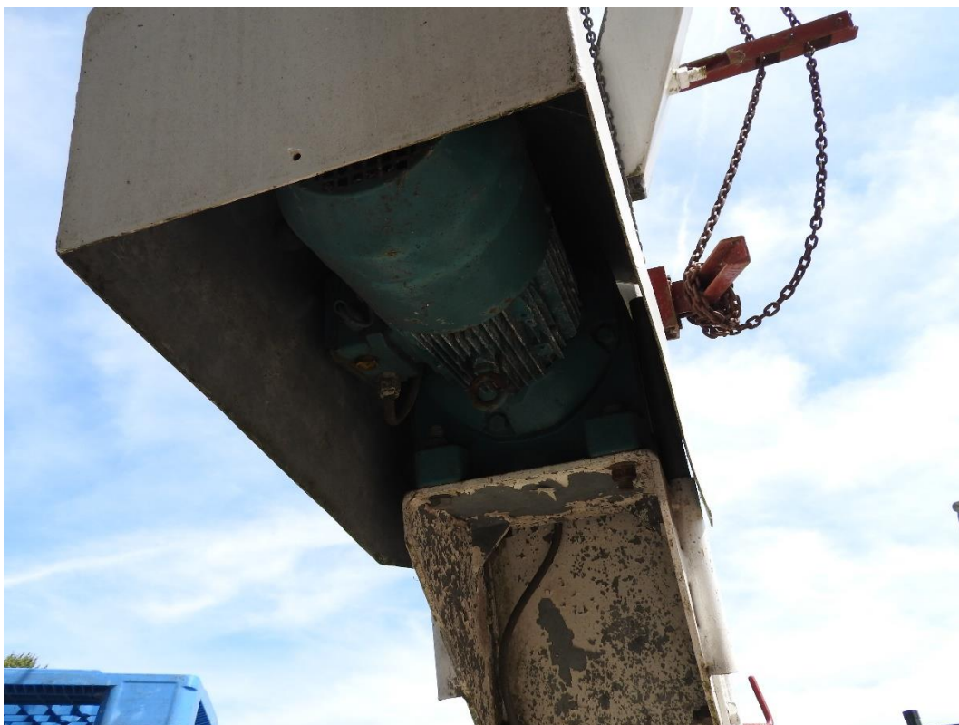
Afbeelding 4.13: De motor die de kruilier aandrijft. Als er geen stroom is, kan de kap van de reductiekast afgenomen worden en kan de kruilier handmatig bediend worden.
