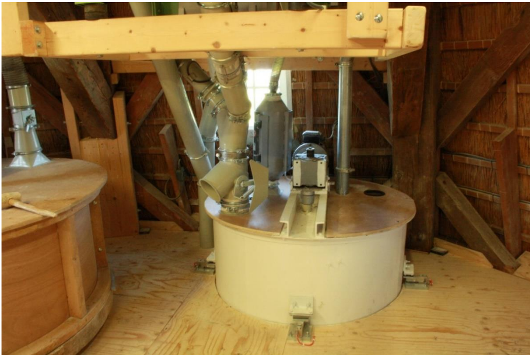
Afbeelding 4.29: Bovenste gedeelte van een menger, op de steenzolder.
