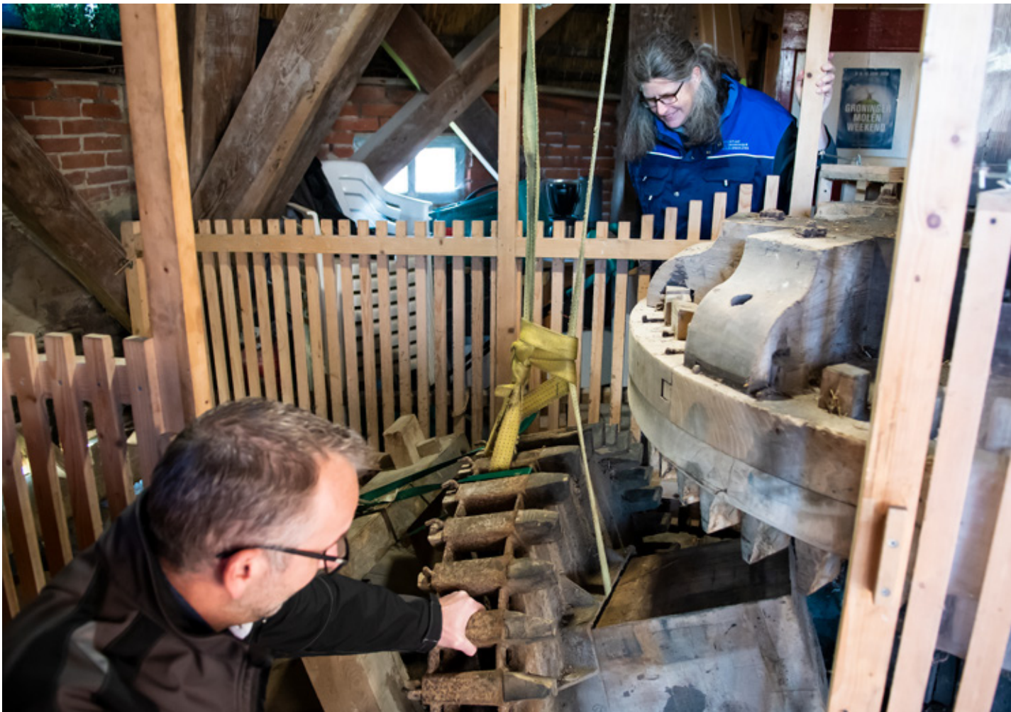
DE KAMMEN VAN HET VIJZELWIEL EN DE ONDERBONKELAAR HET LICHTEN VAN DE VIJZEL UIT DE VIJZELKOM
