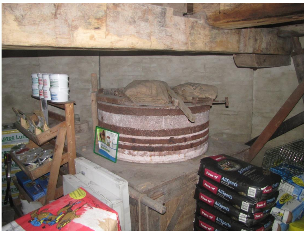
Figuur 79 Koppel kunststenen op de begane grond, aangedreven door de elektromotor. De loper wordt hier van onderen aangedreven.
