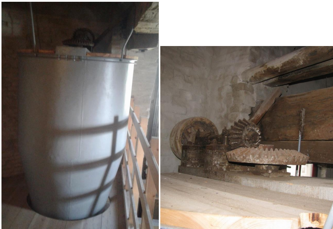
Figuur 83 Mengketel met rechts detail aandrijving.
