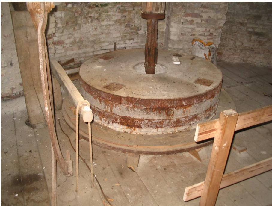
Figuur 64 Koppel kunststenen met afgenomen kuip aan de andere zijde van de molen in 2005.
