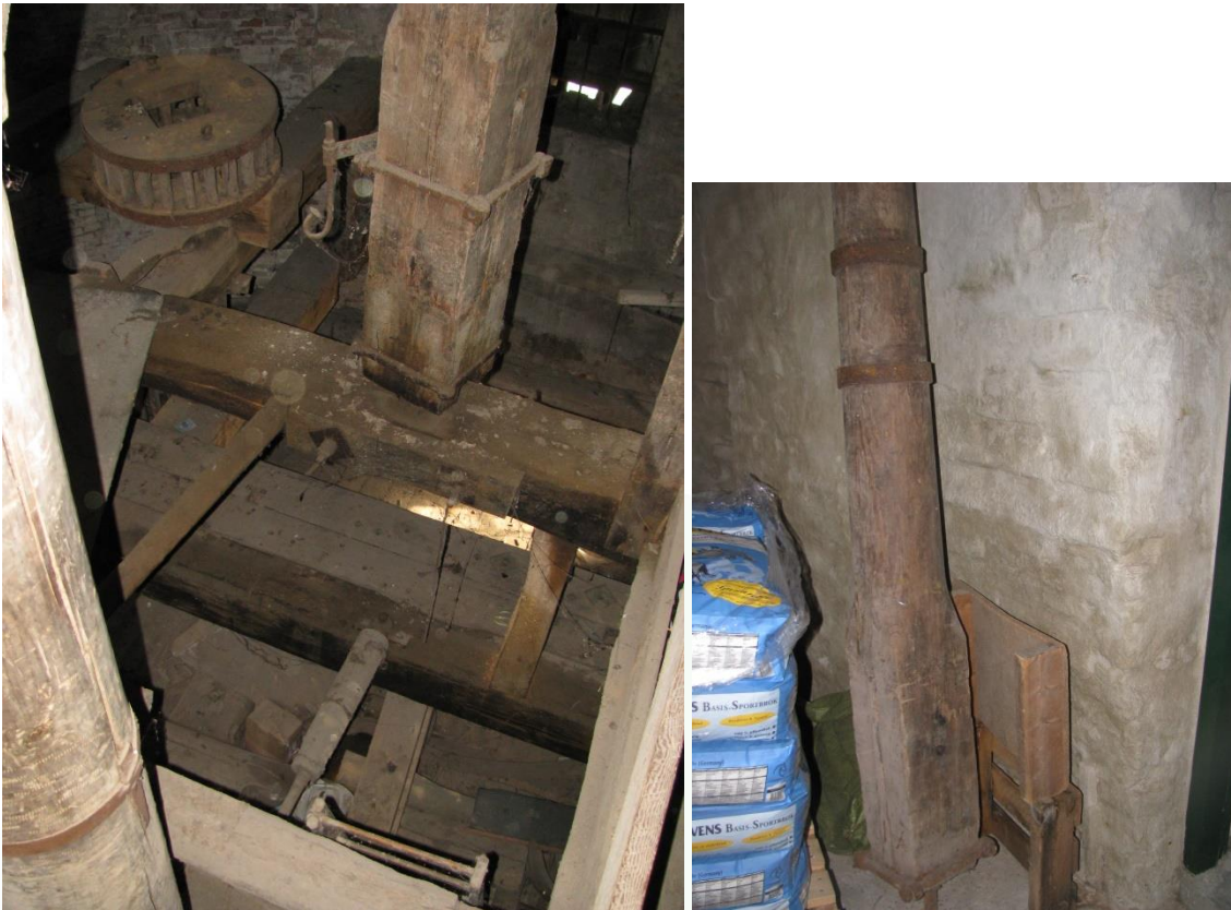
Figuur 68 Op de voorgrond de aandrijfspil, dan een steenschijf en de onderzijde van de takrad-spil. Rechts een over de kop staande maalspil.
