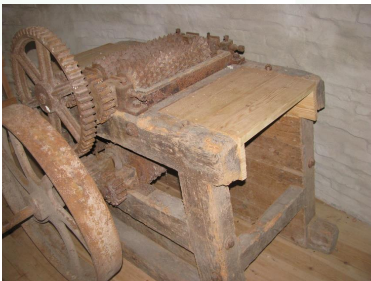
Figuur 82 Koekenbreker met geheel houten frame.
