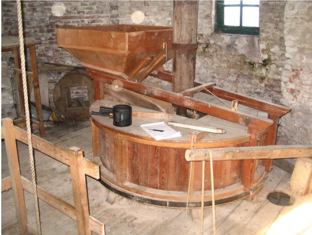
Figuur 63 Maalkoppel met een vrij nieuwe kuip, aan de ene zijde van de molen. Op de achtergrond is nog een schijffloop te zien.
