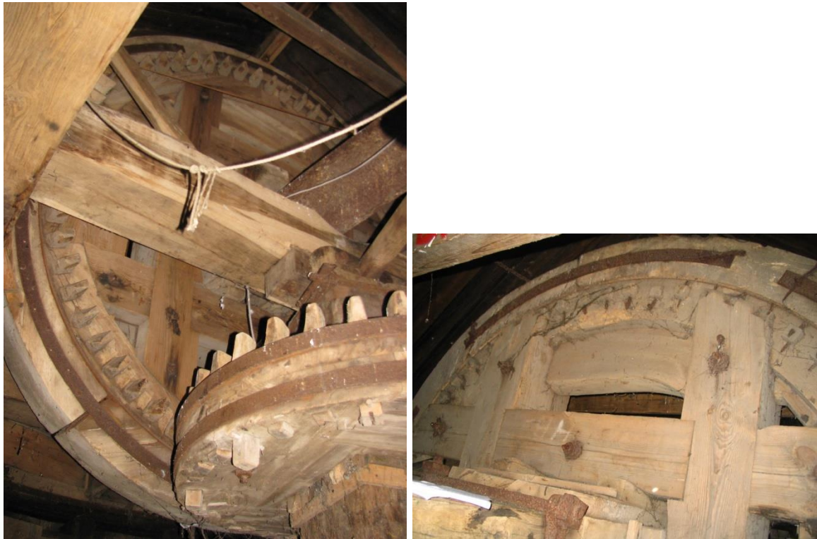
Figuur 52 De grenen voorarmen liggen gelijk met het beleg, de achterarmen zijn over het beleg gekeept.
