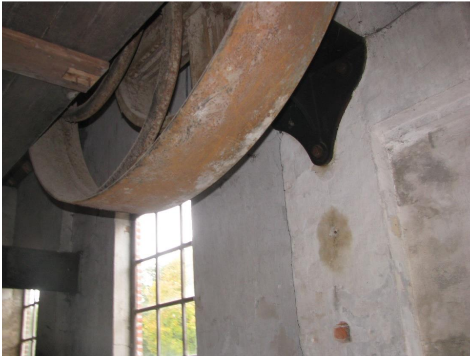
Figuur 74 Eindlager met lagerstoel voor de hoofdas. Dicht bij het lager een houten riemschijf en op de voorgrond een ijzeren riemschijf die door de elektromotor werd aangedreven.
