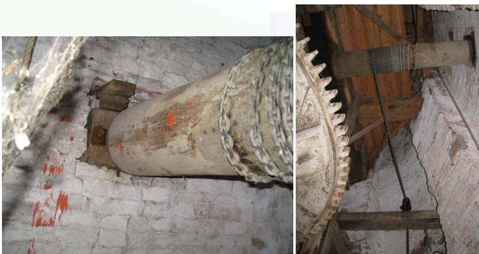
Figuur 60 Links de lagering van de luis in de muur en rechts de schijf voor het luiketting.
