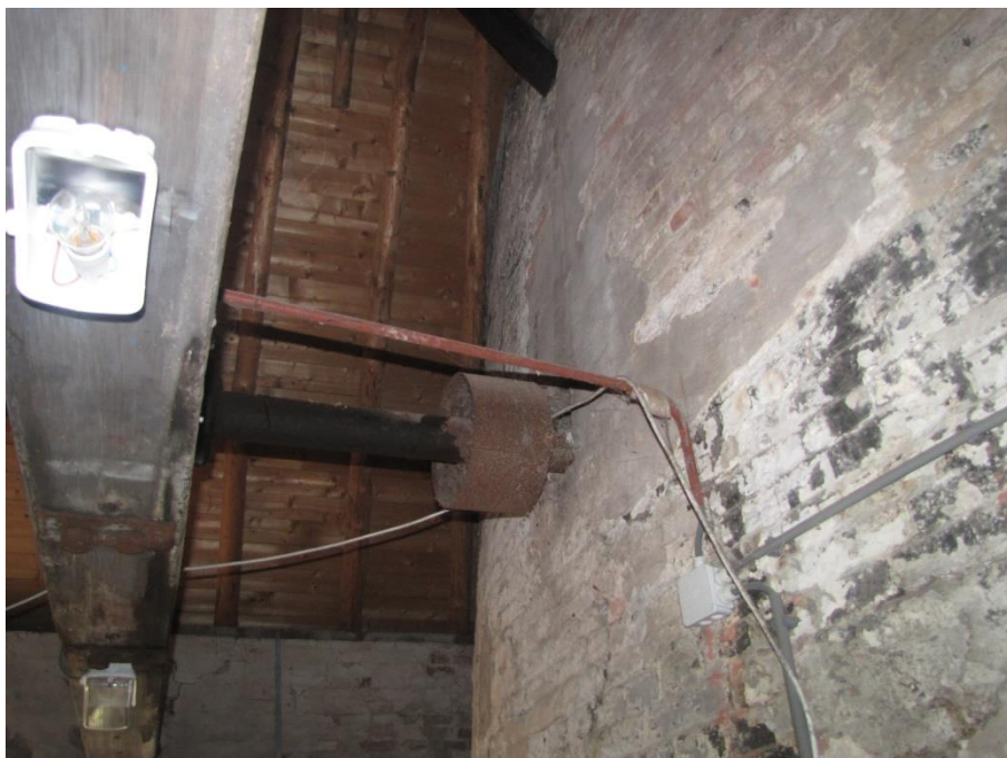
Figuur 76 De hoofdas gaat hier vanuit de machinekamer de molen in.
