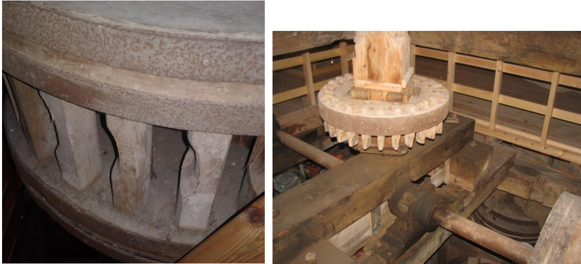
Figuur 70 Detail schijfloop van de vorige foto. Rechts de bonkelaar onder aan deze spil met daaronder de horizontale drijfjas vanaf de elektromotor in de machinekamer. Vanaf de stoommachine zal hier ook een (andere) as hebben gezeten.
