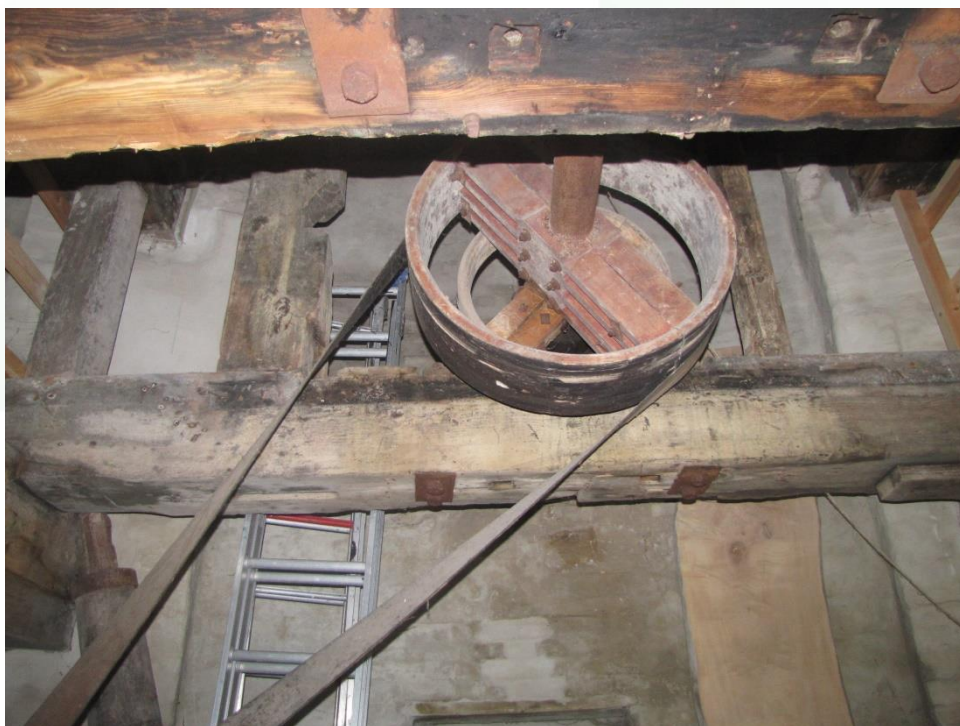
Figuur 77 Andere zijde van de muur waar de hoofdas de molen binnenkomt. De riem op de voorgrond drijft een maalstoel aan.
