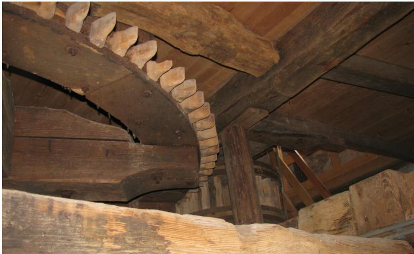
Figuur 69 Takrad met op de achtergrond het aandrijvende schijfloop. Let op slijtzijden van de staven.
