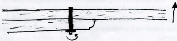
Afb. 3: Te vast aangedraaide strop
