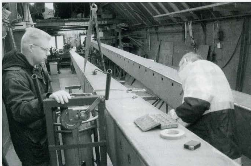
Voorbereidingen voor een röntgenopname: links de röntgenbron en rechts een letterbak voor een code die wordt meefotografeerd
