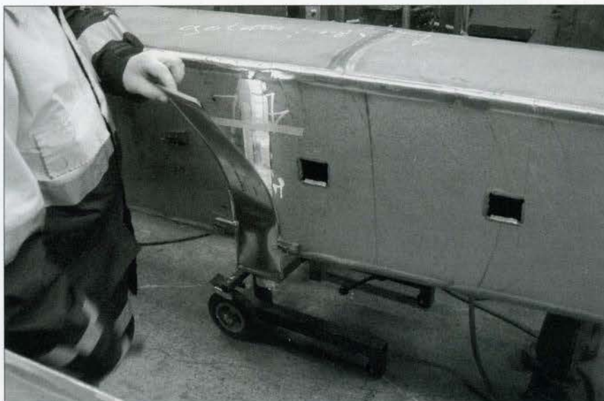
Een laslocatie met (weggebogen) een strip röntgenfilm
