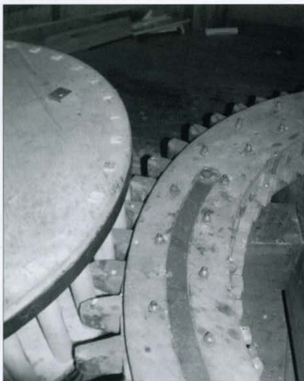
Het takrad en de nieuwe schijfloop voor de eveneens nieuwe vijzel
