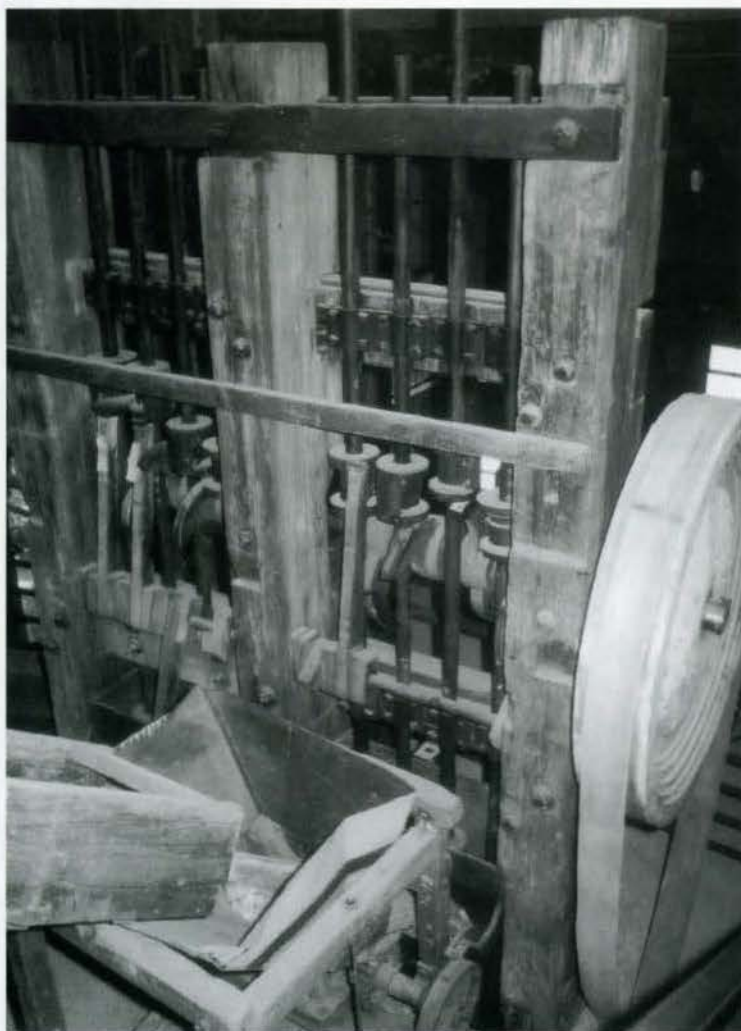
Het slagwerk gezien van de aanvoerside voor het gouderts met rechts het aandrijf wiel vanaf de wateras
