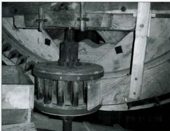
Beveiliging van de indraaijzide van de schijfloop (Vestingmolen, Bourtange) Foto: D.J. van der Zee, Groningen
