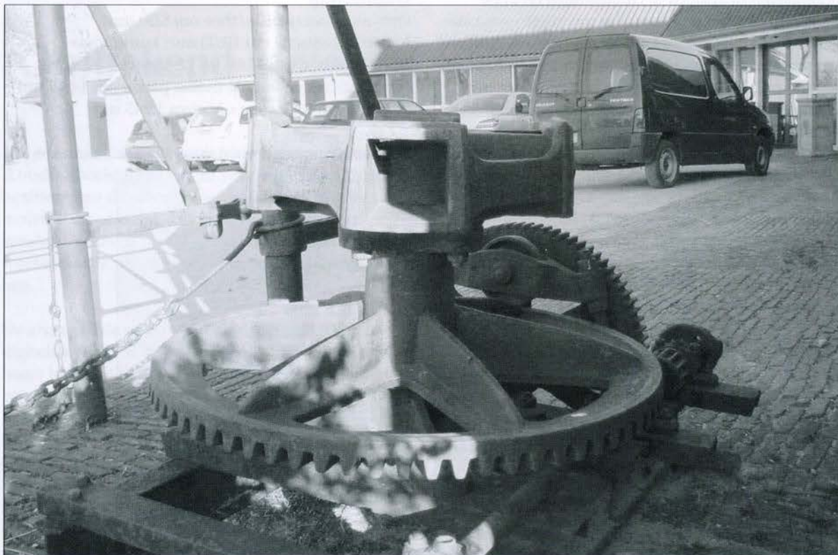
Gietijzeren rosmolenspil, rechts de kruiskoppeling naar de aandrijfjas van het werktuig (Borg Verhildersum)
