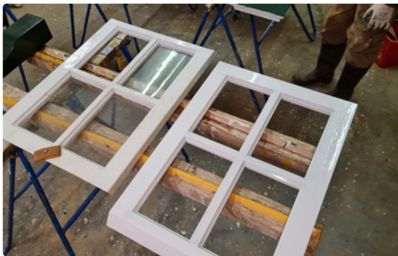
Nieuwe deuren en ramen voor de Windlust in de werkplaats van de molenmaker
