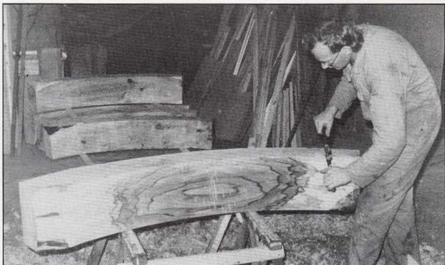
In de werkplaats van de molenmaker wordt de nieuwe vang voor "De Lelie" te Eenrum gemaakt. Op de achtergrond liggen nog vier andere vangstukken gereed. In totaal heeft de vang in verband met het grote bovenwiel, 6 vangstukken.
