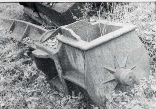
De in de omgeving van Schiedam gevonden bovenas, bestemd voor de molen " Windlust " te Molenrij .
